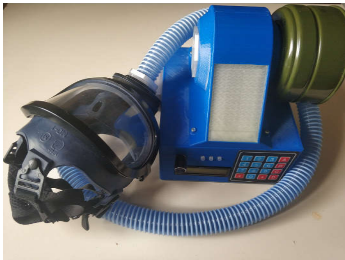
Рисунок 4.9 – Моторизований фільтрувальний респіратор
